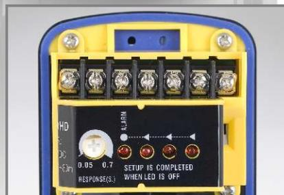
數位式光束強度指示，LED 組成 10 段位階，能快速、準確光學對焦，不需動用三用錶。
